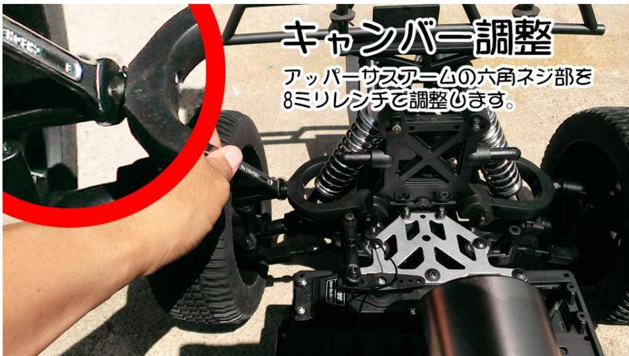
●アッパーサスペンションアームの六角ネジ部を8ミリレンチで調整します。ネジが樹脂部に入っていく方向に回していくと、内側にキャンバー角が付きます。
