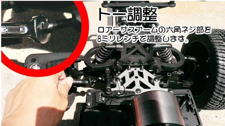
●ローサスペンションアームの六角ネジ部を8ミリレンチで調整します。ネジが樹脂部に入っていく方向に回していくと、前方外側にトー角がつきます（トーアウト）。逆だと前方内側にトー角がつきます（トーイン）。
