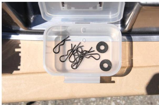
▲外したクリップ（丸いのは、バギーのみで側面のクリップの緩衝剤）
