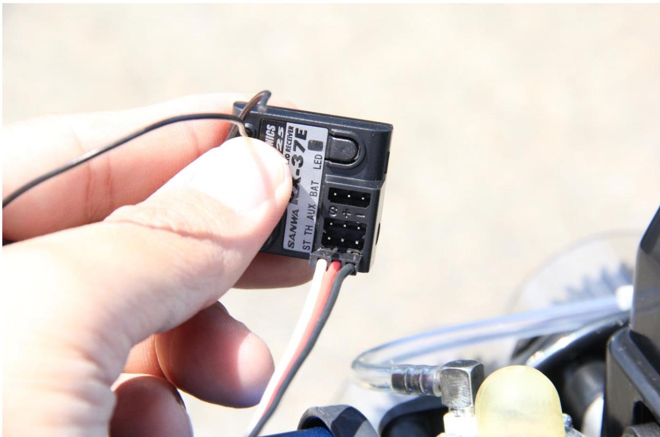
受信機の「ST」を下側に、そしてスロットル制御端子の金属端子が見える面を上にして、接続します。
